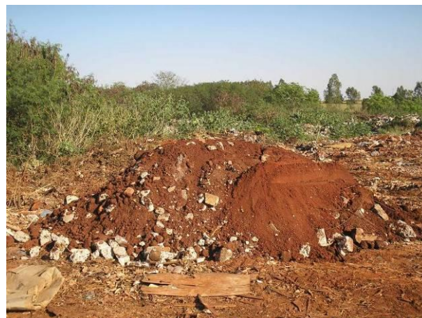
Figura 6 – Resíduos da construção e demolição Classe A disposto no lixão de Japurá/PR
