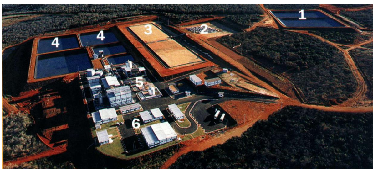
Figura 5. Unidade de Concentração de Urânio (URA): 1 – Tanques de efluentes; 2 – Britador; 3 – Pátio de lixiviação; 4 – Tanques de licor; 5 – Área Industrial e 6 – Área Administrativa).
