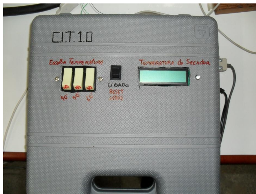
Figura 8 - Controlador e Indicador de Temperatura (CIT versão 1.0).
