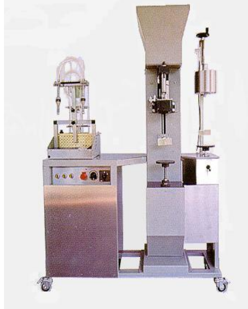
Figura 2. Máquina para engarrafamento do vinho, colocação da rolha e da cápsula na garrafa. (Hoffmann, 2008).
