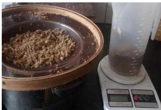
FIGURA 1: Peneiramento das fibras. Fonte: Autor (2015).
