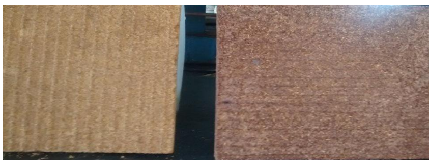
FIGURA 9: Resultado do ensaio de envelhecimento, painéis A (50/50) e B (30/70). Fonte: Autor (2015).
