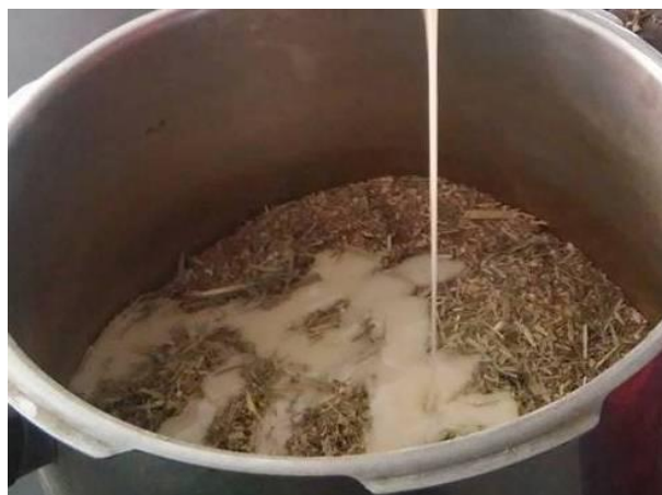
FIGURA 5: Mistura da cola com as fibras soja, serragem e aveia. Fonte: Autor (2015).
