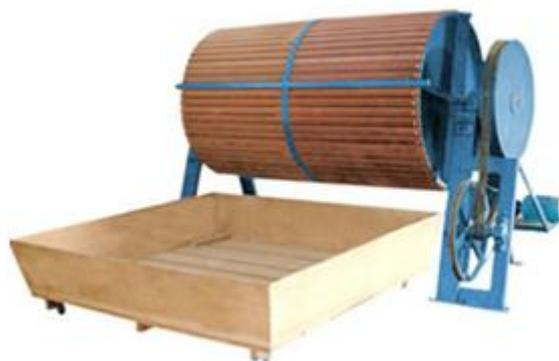
Figura 2 – Lavador-descascador. Fonte: Eminox.
