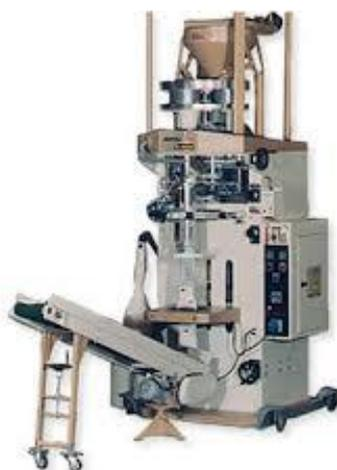
Figura 11 - Embaladora automática. Fonte: LEMAQUI Equipamentos Industriais.
