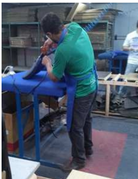
FIGURA 9 – Operário realizando o grampeamento de fita plástica de acabamento de cadeiras – Parte I
