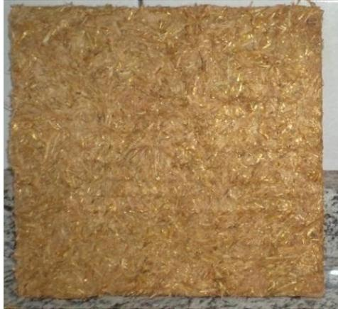
Figura 2 – Placa de fibras, aveia e cana-de-açúcar.
