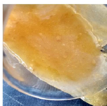
FIGURA 5c - Fluidez e viscosidade do hot melt produzido com ATP 1 em estado líquido e temperatura elevada.
