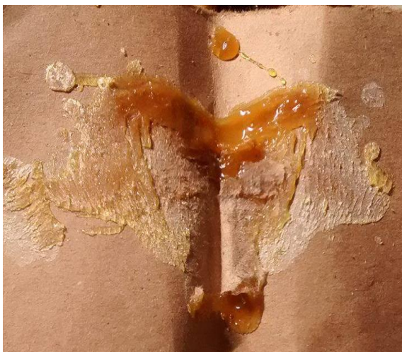
FIGURA 8 a - Teste da colagem do hot melt produzido com o ATP 2 .
