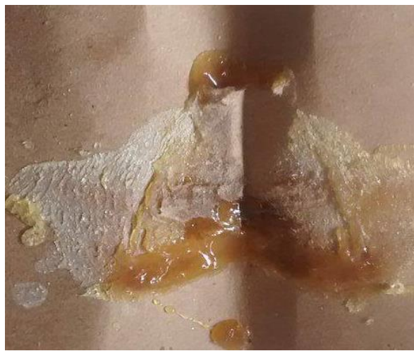
FIGURA 8b - Teste da colagem do hot melt produzido com o ATP 2 .
