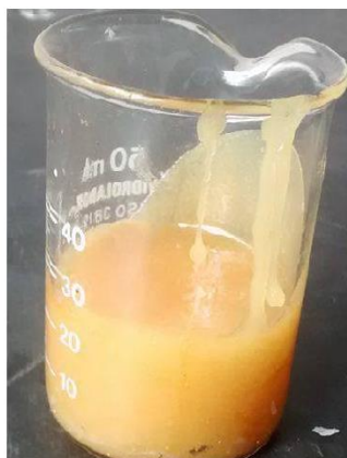
FIGURA 5b - Hot melt produzido com ATP 1 em estado líquido e temperatura elevada.
