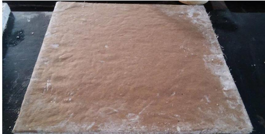
FIGURA 4 - Painel de gesso acartonado e fibra de milho. Fonte: Autor (2016).
