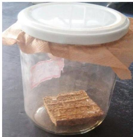
Figura 4 – Corpos de prova em vidros vedados. Fonte: Autor (2016).
