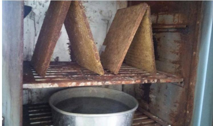
Figura 3 – Ensaio de Envelhecimento. Fonte: Autor (2016).
