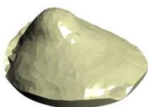
Figura 1 – Modelo 3D gerado a partir do escaneamento por apalpamento
