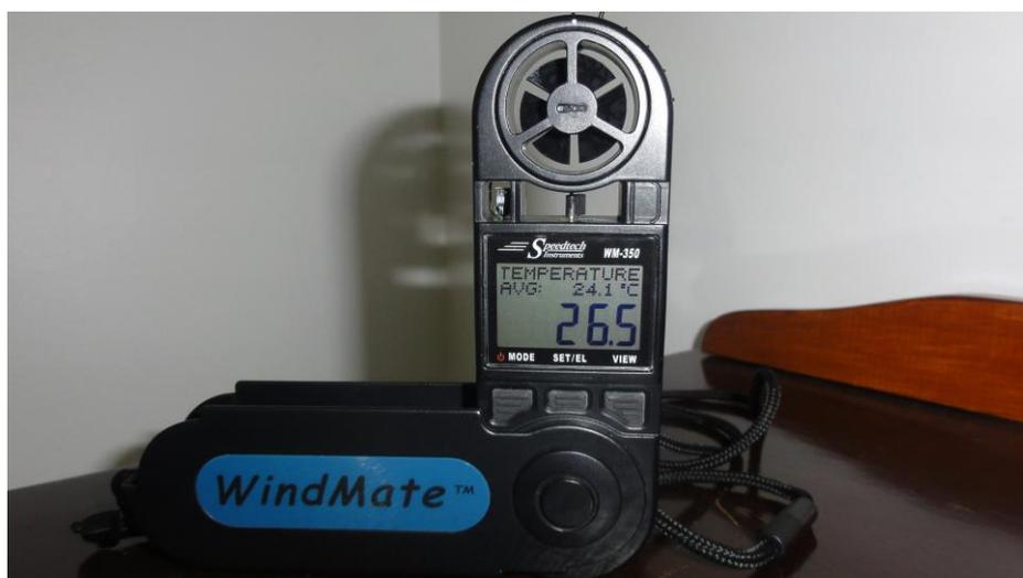
**Figura 3 - Monitor meteorológico portátil (Speedtech), modelo: WindMate 350 Weather Meter.**
